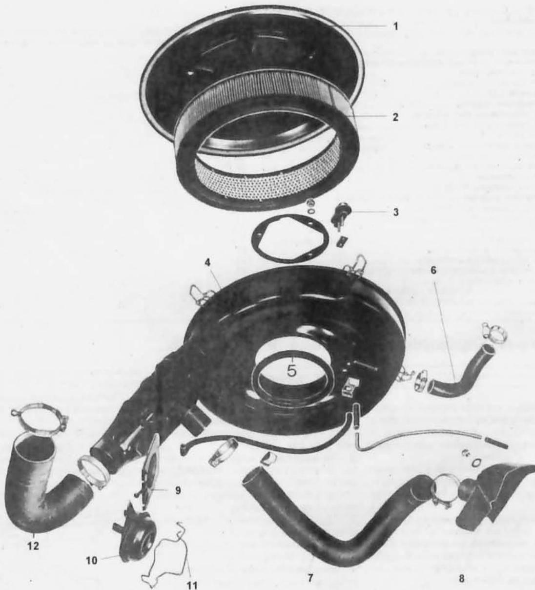
Рис. 3.2 Сборка воздушного фильтра и компоненты автоматической регулировки температуры воздуха (Главы 3 и 4)
